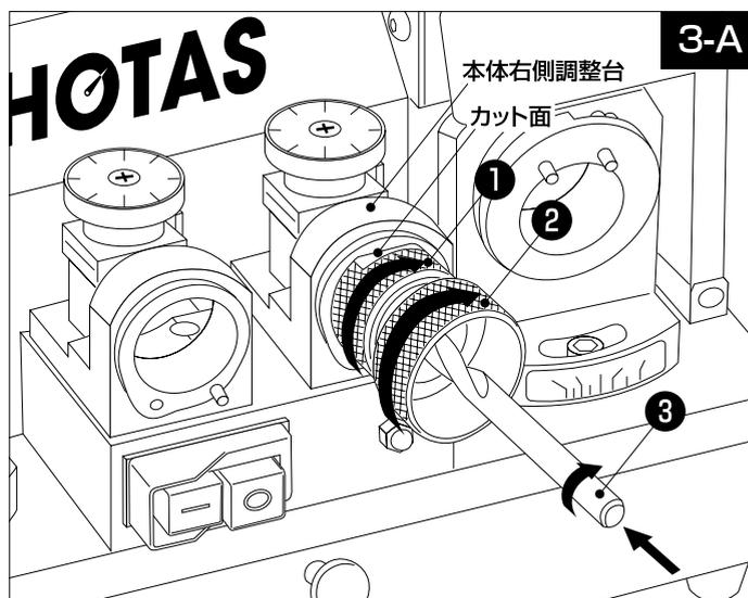
注意：この時必要以上の強い力で締め付けないようにしてください。調整台の故障やストッパーの磨耗の原因になります。また、φ2～φ4程度の小径ドリルの場合、ストッパーでの当たりがとりにくい場合がありますが、あらかじめコレットとドリルのギャップをできるだけ小さくし、軽い力で回転させることにより比較的楽に当たりを取ることができます。
